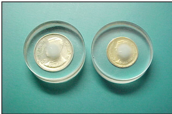
ภาพที่ 2 เหรียญตัวอย่างผ่านการหล่อขึ้นรูปในเรซินใส
